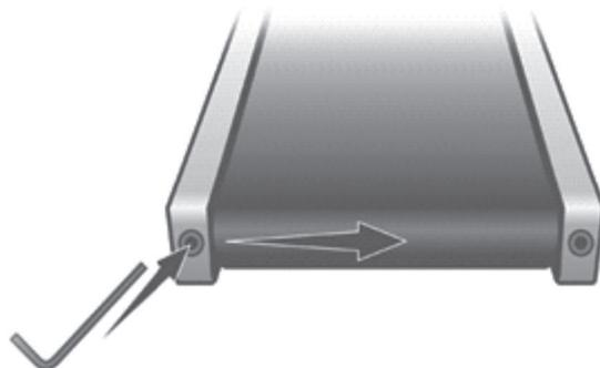
Для выполнения такой регулировки используется ключ для внутреннего шестигранника [идет в комплекте]. Установите скорость полотна 12 км/час. Помните, процесс регулировки инерционен. Поэтому после каждого регулировочного действия необходимо выждать до 1 мин. что бы убедиться в том, что беговое полотно смещается в нужную сторону на необходимую величину.
