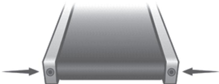
В случае появления проскальзывания необходимо на выключенной беговой дорожке повернуть оба регулировочных винта по часовой стрелке на  $\frac{1}{4}$  оборота. После этого необходимо провести проверку. Если проскальзывание осталось, то процедуру необходимо повторять до устранения проскальзывания. Если в процессе регулировки суммарно угол поворота составил один оборот и проскальзывание не устраняется - необходимо прекратить регулировку и обратиться в сервисный центр
