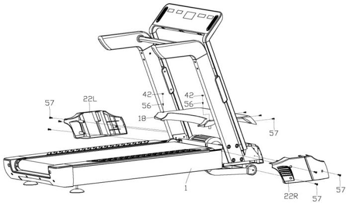
Установите кожух моторного отсека (18) на основную раму (1) и зафиксируйте кожух моторного отсека (18) на основной раме (1) с помощью винтов (56) и винтов (57).
